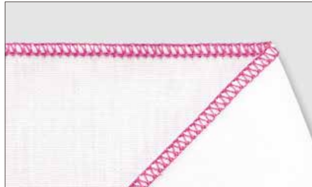
巻きロック (P16参照) オーガンジーやジョーゼットなど、薄物の縁かがりに最適。パーティードレスなどのフリルやコサージュ作りには欠かせません。もちろん巻きロックでも縫い合わせができます。
